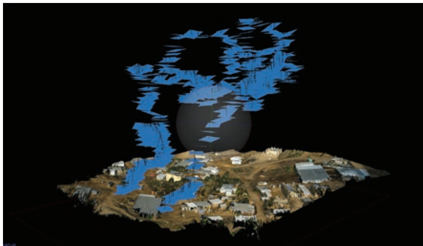
Maqueta realizada con fotogrametría en la que se aprecia la ubicación de las cámaras atadas a cometas. Poblado beduino no reconocido de Atir, zona norte del Néguev, 2016. Ariel Caine / Forensic Architecture.
